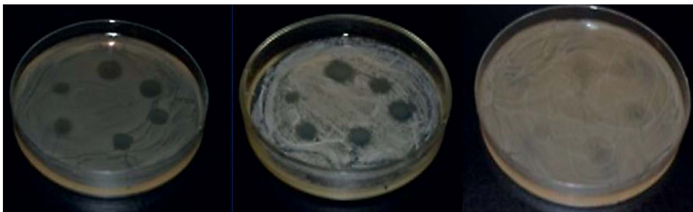
Рис. 6. Определение активности средств с фитонцидами сосны и разными композициями эфирных масел на культуры микроорганизмов: слева направо – Klebsiella pneumoniae , Candida albicans , Lactobacillum ssp. На чашках четко видны зоны подавления роста микроорганизмов в местах нанесения средств на основе разных композиций фитонцидов*.
