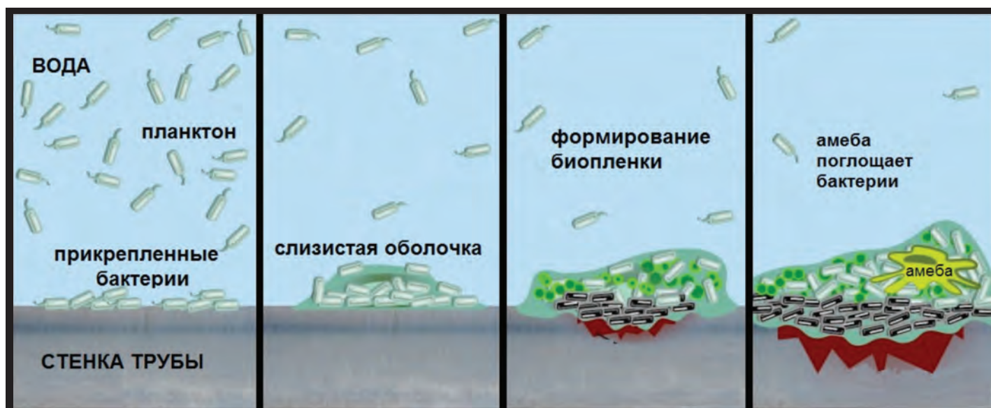
Рис. 4. Механизм образования биопленок [32].
