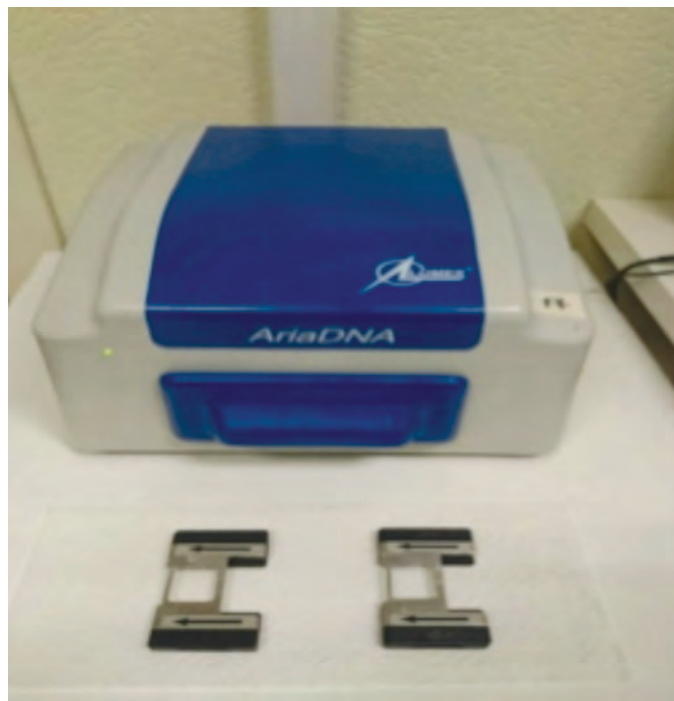
Рис. 3. Микрочиповый ПЦР-РВ амплификатор «АриаДНА», ООО «Люмекс-маркетинг».
